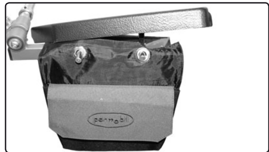
Bild 6. Återmontera armstödsplasten. Väskans överdel skall klämmas fast under plasten.
