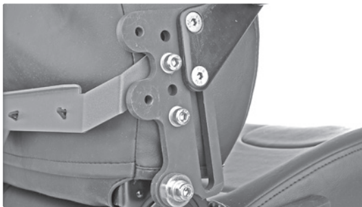
Bild 7. Armstödet infästning med monteringshål.
