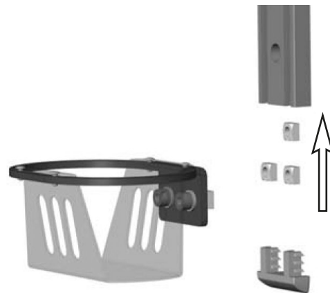
Bild 2. Montering av fästet på skenan för CS.
