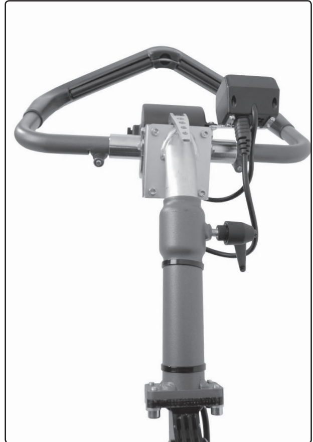
Bild 3. Kablaget fäst med buntband.
