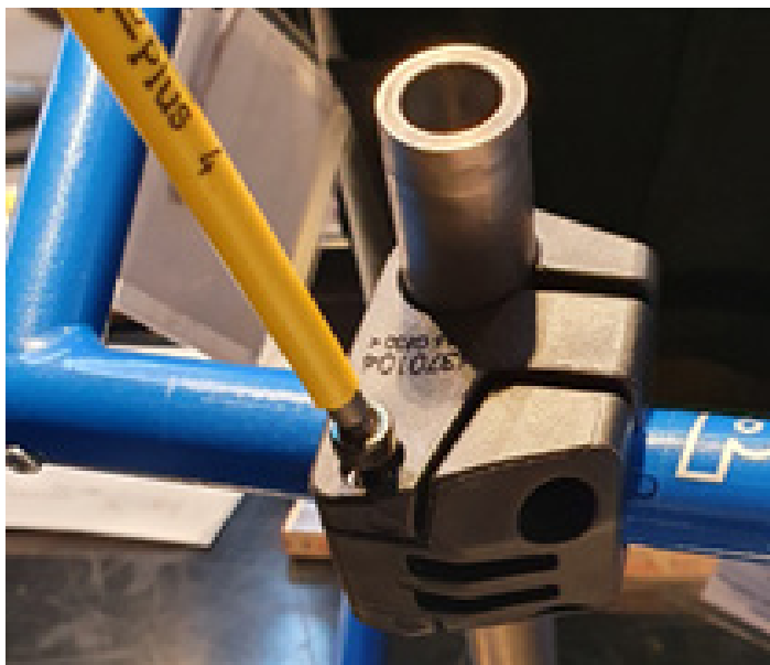
Fig.3 Montera nu på klämma övre, pos.3 tillsammans med Bult M5x35,pos.4 så att klämman, pos.2 och 3 sitter ihop (Fig 1)
