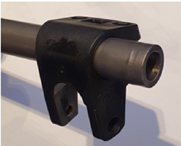
Fig.2 Trä på klämman undre, pos.2, på vardera sida av bakaxeln, pos.1 (Fig 1)
