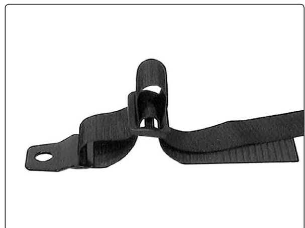
Bältesfästena monteras med remlås. Var noga med att den kortare delen av bältet hamnar underst så den kläms fast.
