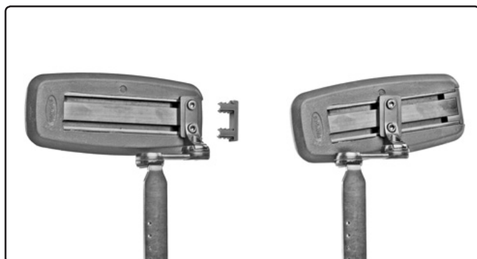
Bild 7. Hopmontering av kudde och fäste. Till vänster. Om kudden har en plastplugg tas den bort. Därefter skjuts fästets muttrar in i kuddens skårar. Till höger. Fixera kudden i önskat läge genom att dra åt skruvarna. Återmontera eventuell plastplugg.
