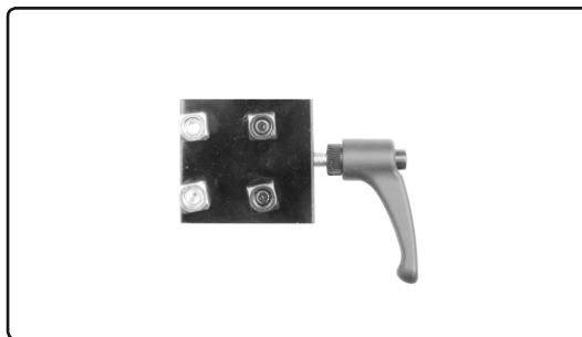
Bild 2. Montera de två M6x12 skruvarna och fyrkantmuttrarna i tillbehörsfästet. Muttrarna skruvas in endast några varv på skruvarna.
