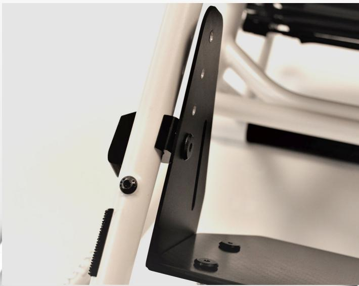
3. Placera fotplatta och klämma runt ramröret, dra åt skruven lätt
