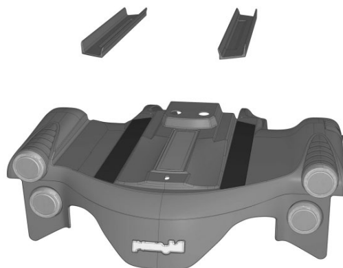
Bild 5. Dra av skyddstejpen och montera klämskydden på chassikåpens markerade ytor.
