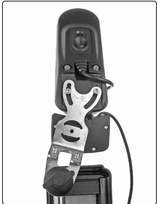
Bild 8. Justering i förhållande till armstödet mitt. Lossa skruvvredet, vrid till önskat läge.
