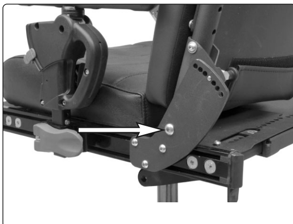
Ryggstödet sitter monterat med en skruv och mutter på sitsens vänstra resp. högra sida.
