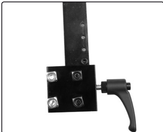
Bild 10. Skruvhål och stoppskruv för fixering av stödets höjdläget.
