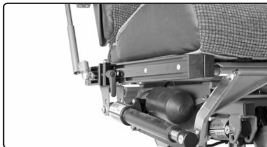
Bild 9. Fästehållaren monterad i tillbehörsskenan.
