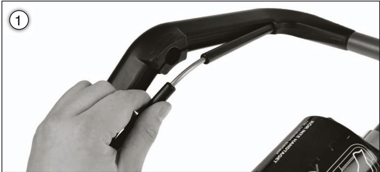
Bild 1. Pressa in fingrarna underifrån på säkerhetsgreppet och dra utåt för att få lös stangen från hållaren i mitten av gummihandtaget.
