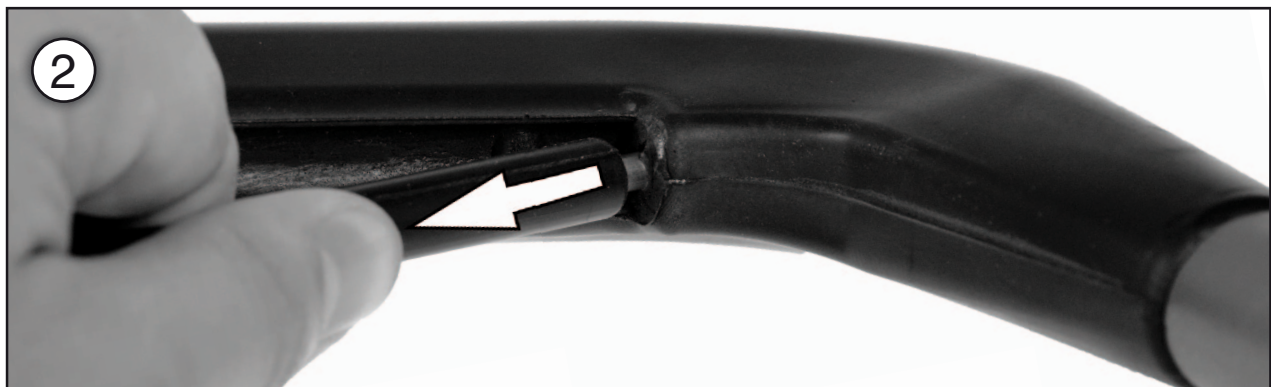
Bild 1. Pressa in fingrarna underifrån på säkerhetsgreppet och dra utåt för att få lös stangen från hållaren i mitten av gummihandtaget.
