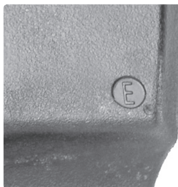
Bild 8. Den ingjutna bokstaven för identifiering.
