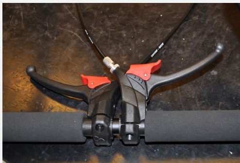
Fig. 23 Om körhandtaget är mycket smalt, 33cm och under, kan man behöva lägga bromshandtagen om lott som bilden visar för att få plats.
