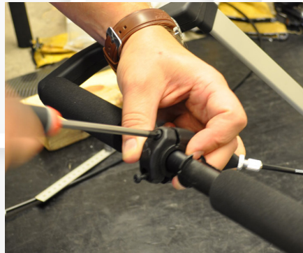
Fig. 21 Monter dit bromshandtagen och drag åt överfallen
