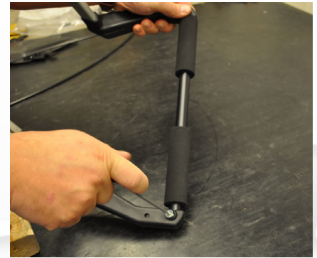
Fig. 22 Montera tillbaka de två tillkapade delarna av skumplasten på körbågen och montera tillbaka skruven.
