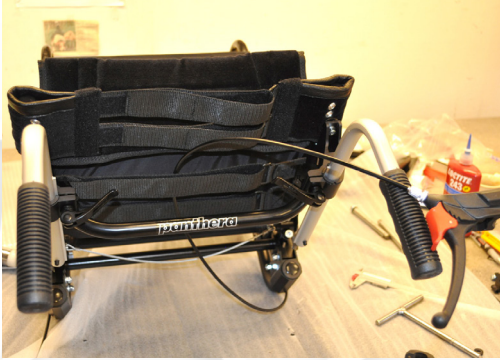
Fig. 13 Montera dit körhandtagen i ryggfästena och dra igenom bromsvajrarna i ryggen.
