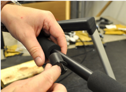
Fig. 20 Montera dit plasthylsorna som följer med i bromssatsen runt rören på körbågen på båda sidor.
