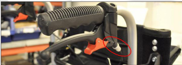
Fig. 13 Montera dit körhandtagen i ryggfästena och dra igenom bromsvajrarna i ryggen.
