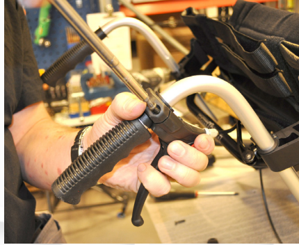
Fig. 14 Skruva fast bromshandtagen på körhandtagen.
