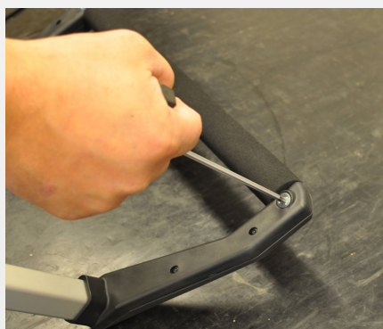
Fig. 18 Lossa skruven på ena sidan med insexnyckel 4mm.
