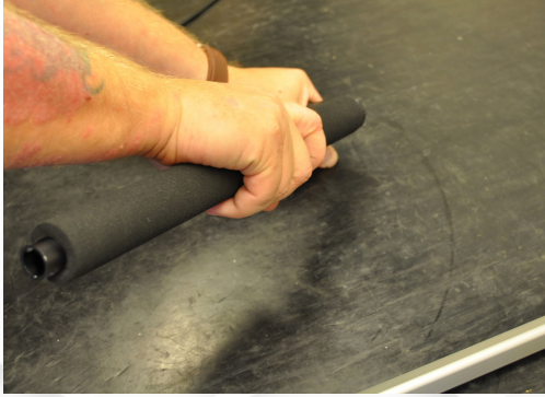
Fig. 20 Drag loss skumplasten från körhandtaget. Sitter det hårt kan man blåsa in tryckluft för att underlätta demontering.
